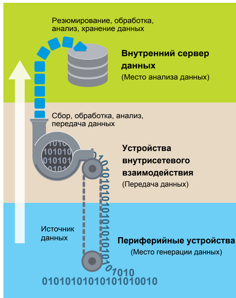
Рисунок 1: Модель обработки данных для задач IIoT
